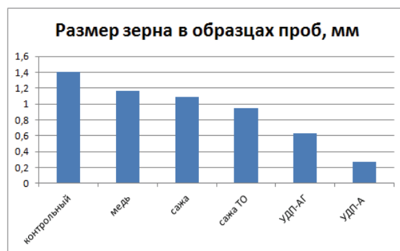
Рис. 6. Размер зерна образцов, отлитых в землю
