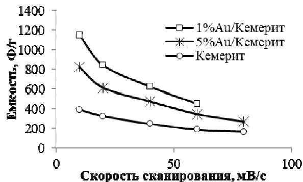
Рис. 5. Зависимости емкости композитных электродов от скорости сканирования потенциала и содержания золота в композите
