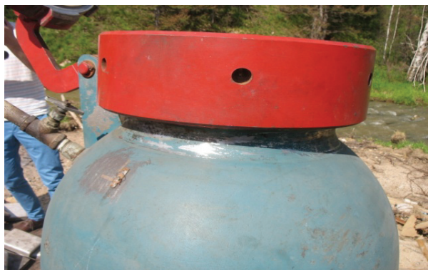
Рис. 4. Верхняя часть камеры с байонетным механизмом закрытия
