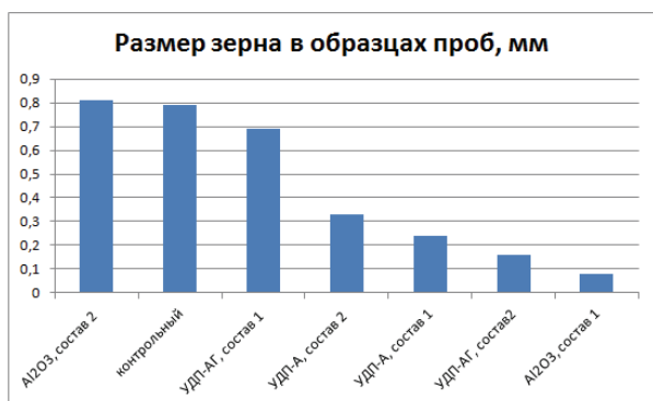
Рис. 7. Размер зерна образцов, отлитых в кокиль
