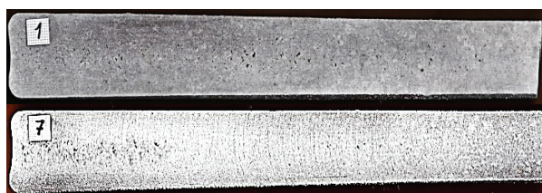
Рис. 3. Макроструктура базового (вверху) и модифицированного (внизу) наноалмазами сплава АК12
